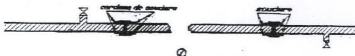
Remise en service de la canalisation et soudure des manchons de raccordement en cours de pompage.
