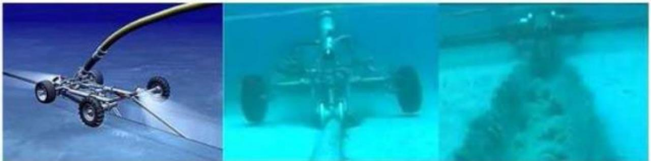
**Figure 4 . 12: Machine de lanage automotrice**
