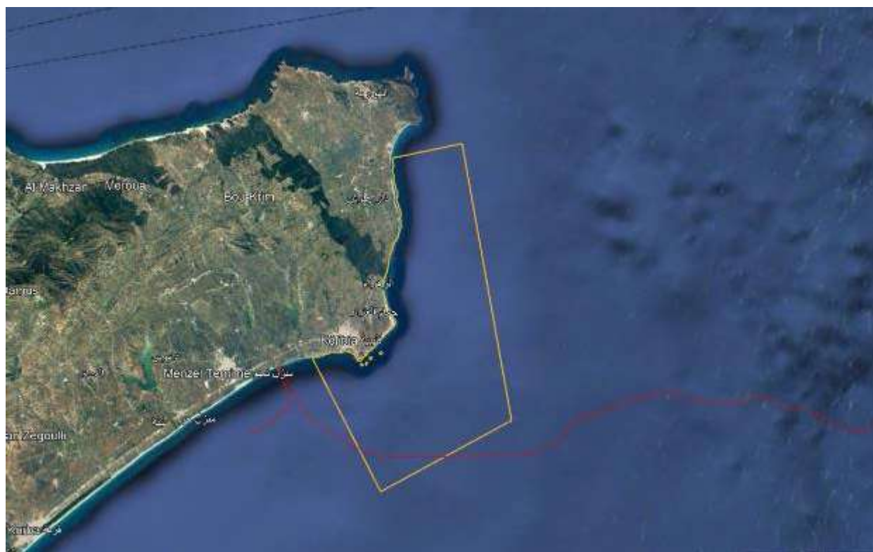
Figure 7 . 9: Tracé du câble (en rouge) à travers Kelibia IMMA (périmètre en jaune)
